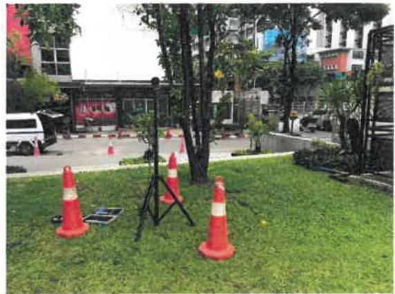
รูปที่ 2-19 แสดงการติดตั้งเครื่องตรวจวัดคุณภาพอากาศ เสียง และความสั่นสะเทือนไว้ในพื้นที่ก่อสร้าง และพื้นที่คณะสาธารณสุขศาสตร์ มหิดล
