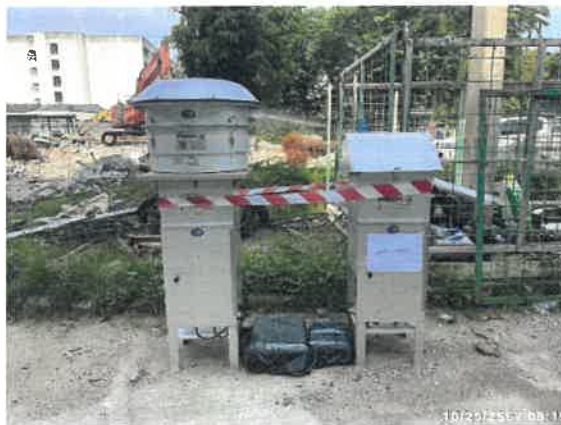
รูปที่ 2-11 แสดงการติดตั้งเครื่องตรวจวัดคุณภาพอากาศไว้ในพื้นที่ก่อสร้าง
