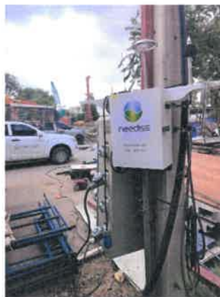
รูปที่ 2-12 แสดงการติดตั้งระบบตรวจสอบค่าความเข้มข้นของ PM 2.5 PM 10 และระดับเสียง แบบการประมวลผลทันที (Real time) ผ่านหน้าจอแสดงผลไว้ด้านหน้าโครงการ
