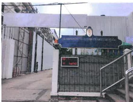
รูปที่ 2-12 แสดงการติดตั้งระบบตรวจสอบค่าความเข้มข้นของ PM 2.5 PM 10 และระดับเสียง แบบการประมวลผลทันที (Real time) ผ่านหน้าจอแสดงผลไว้ด้านหน้าโครงการ
